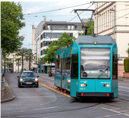
Abb. 4: Leitschwellen mit biegsamen und überfahrbaren Absperrpfosten in der Hedderichstraße.
